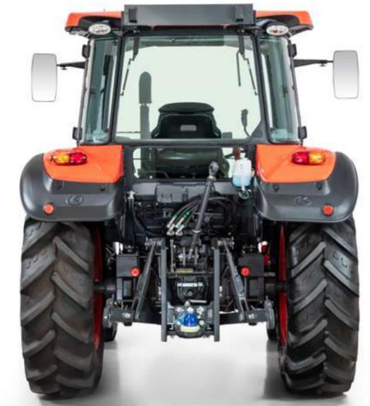
Mit 2.500 kg Hubkraft steht Ihnen die Welt der Anbaugeräte offen – selbst schwere Maschinen sind kein Problem. Das Ankoppeln funktioniert mit den verstellbaren Kat. II-Unteren schnell und einfach. Damit Sie Ihr Anbaugerät sicher und präzise steuern können, verfügt die Hydraulik über einen Lagereglер für die optimale Position. Und mit dem Automatik-Zugmaul sind Sie auch für Transportarbeiten bestens gerüstet.
