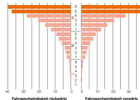
Geschwindigkeitsdiagramm M4003 36V/36R
